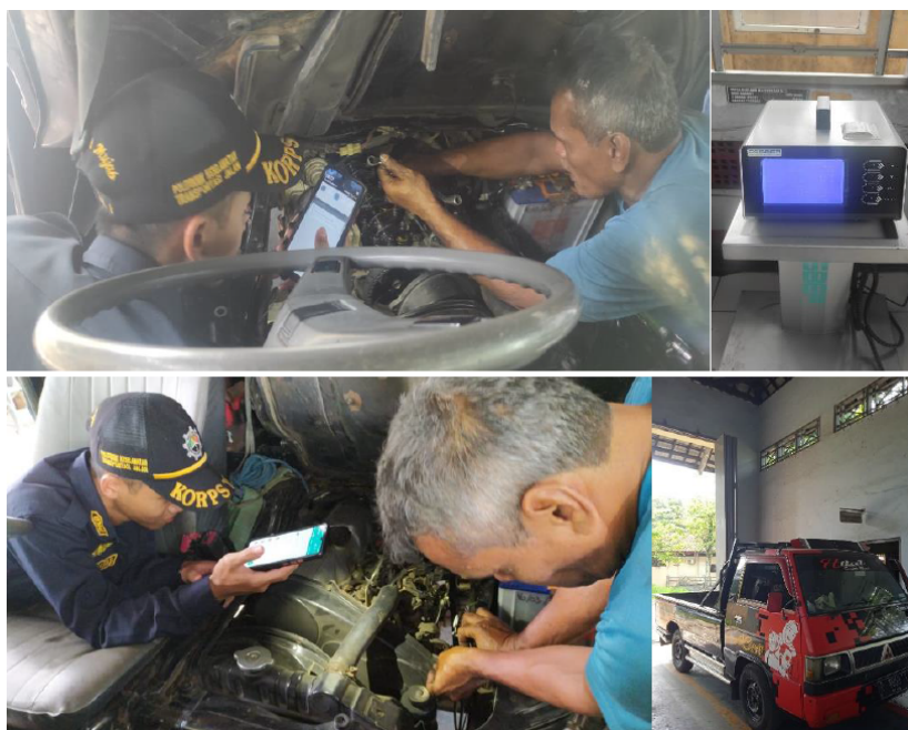
Gambar 1. Prosedur penyetelan celah katup mengikuti urutan Top Kompresi 1 dan 4
